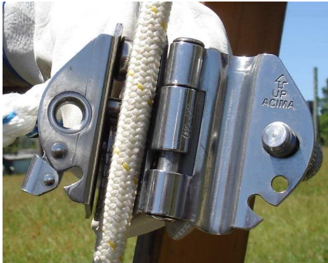
Figura 29 - Instalação do trava-quedas na linha de vida
