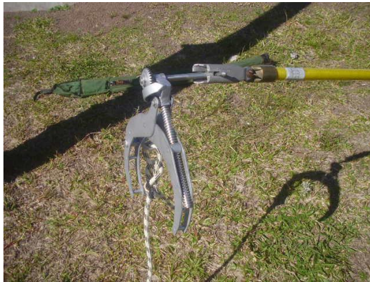
Figura 21 - Encaixe da garra na ponteira da vara de manobra
