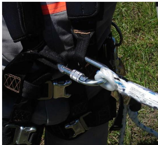
Figura 28 - Instalação do trava-quedas no cinto paraquedista
