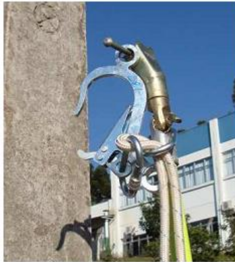
Figura 23 - Instalação do gancho no cabeçote da vara de manobra
