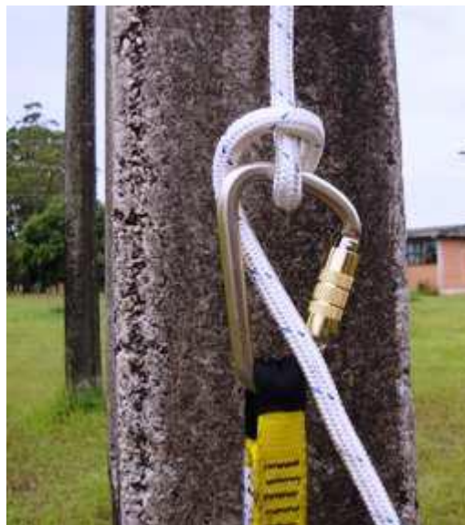
Figura 14 - Ajuste do nó de freio
