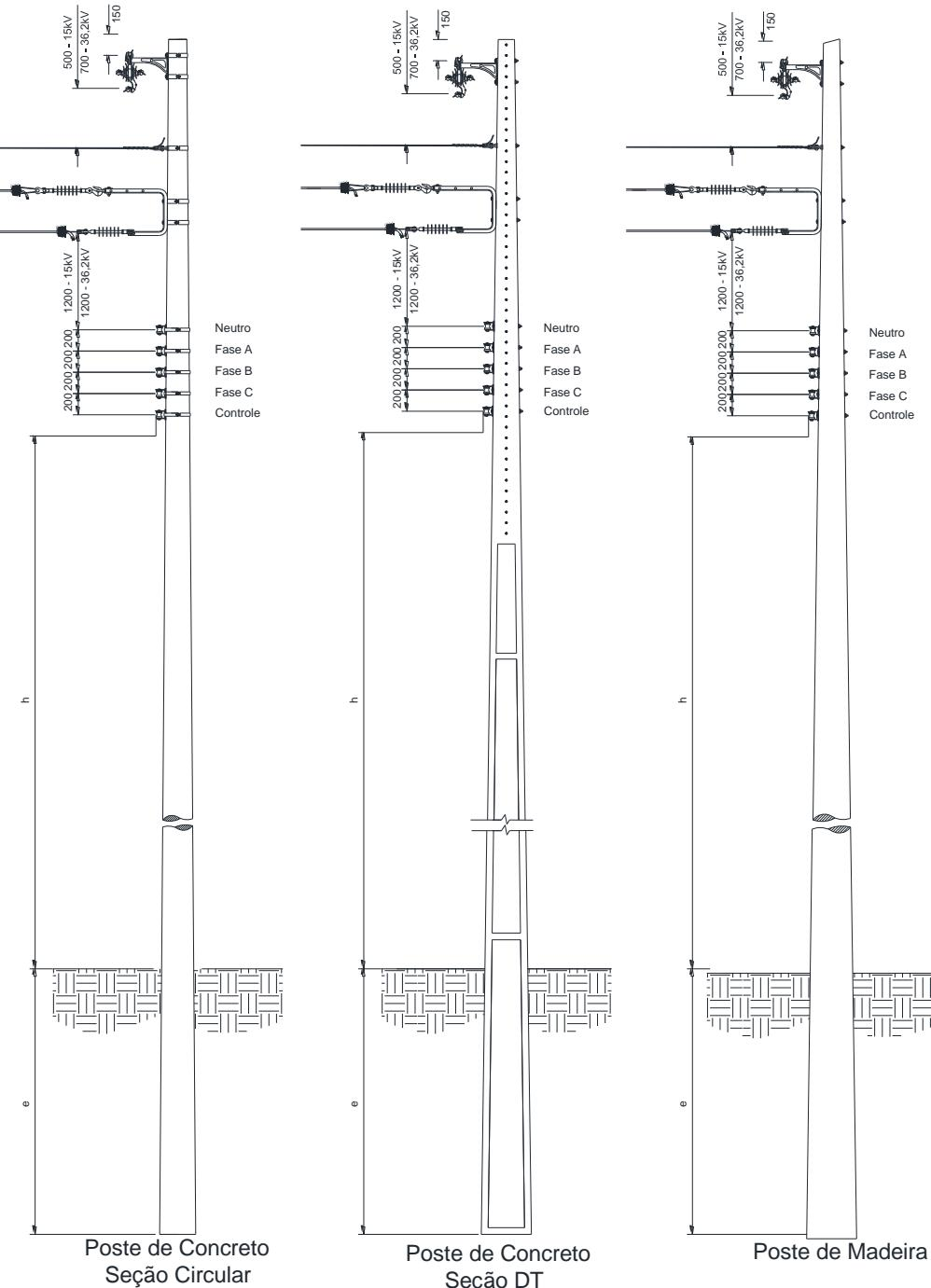
Figura 9 – Afastamentos mínimos – Estruturas trifásicas tangentes com derivações
