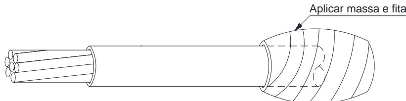
Figura 97 – Conexões e emendas – Rabicho
