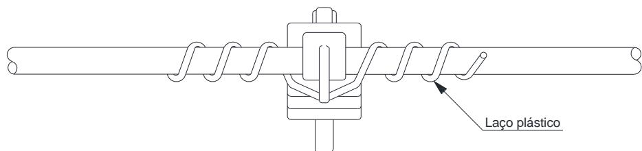
Figura 81 – Amarrações e ligações – Amarração do cabo protegido em espaçador monofásico, vertical e losangular – Laço plástico
