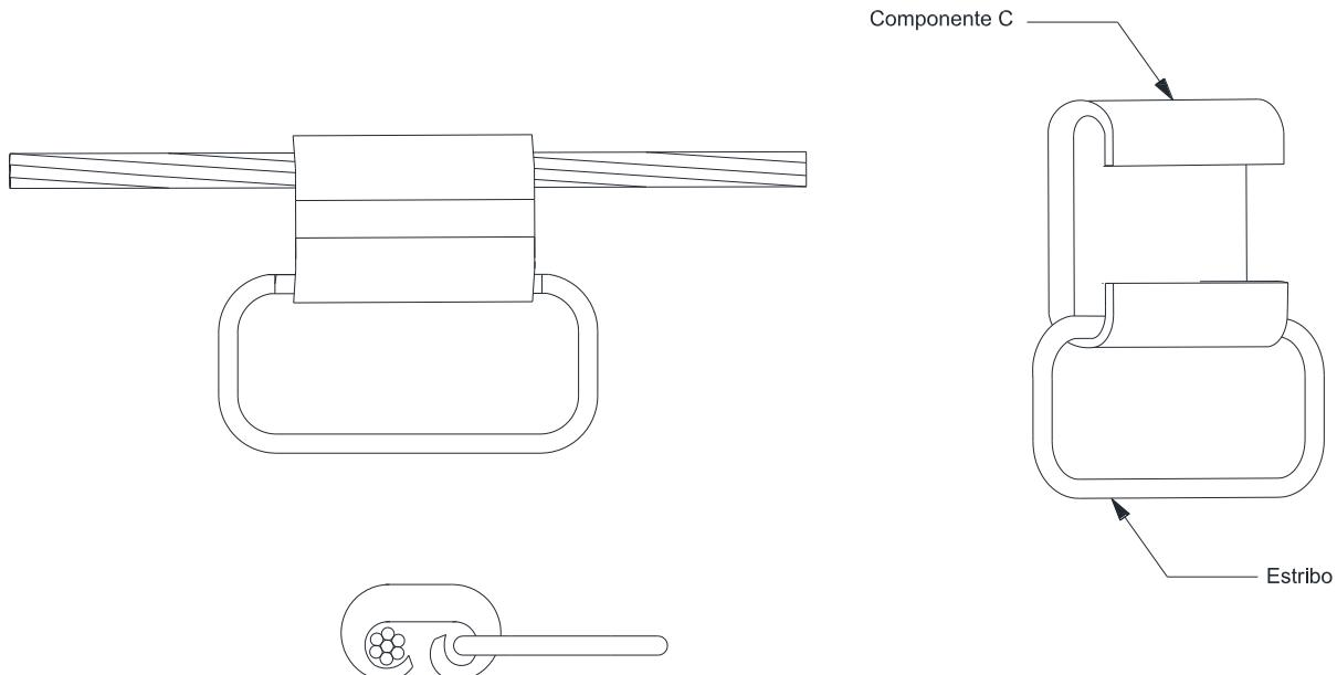
Figura 91 – Conexões e emendas – Conector de compressão tipo “C” com estríbo
