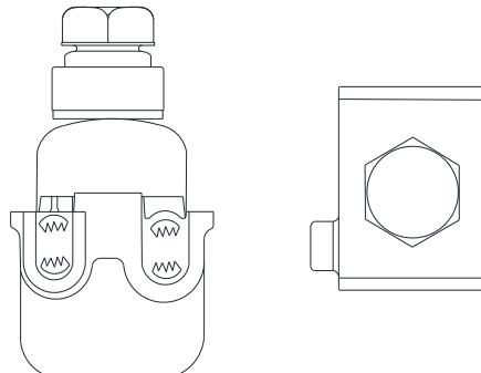
Figura 94 – Conexões e emendas – Piercing
