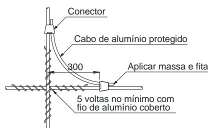
Detalhe da conexão do cabo mensageiro
