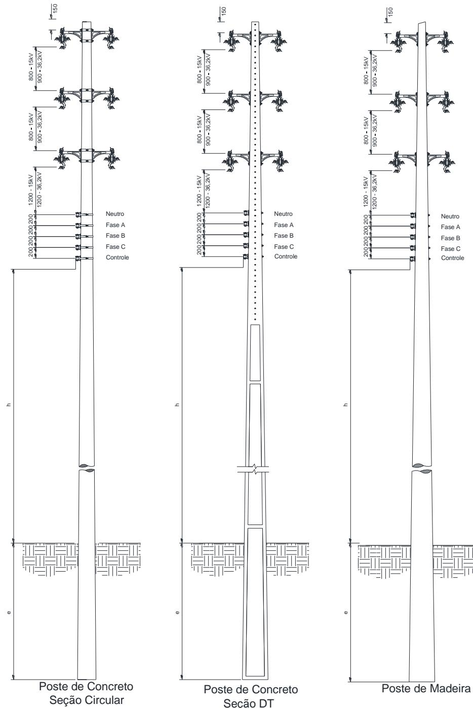
Figura 13 – Afastamentos mínimos – Estruturas trifásicas tangentes
