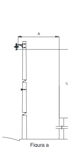
Afastamentos horizontal e vertical entre os condutores e o muro
