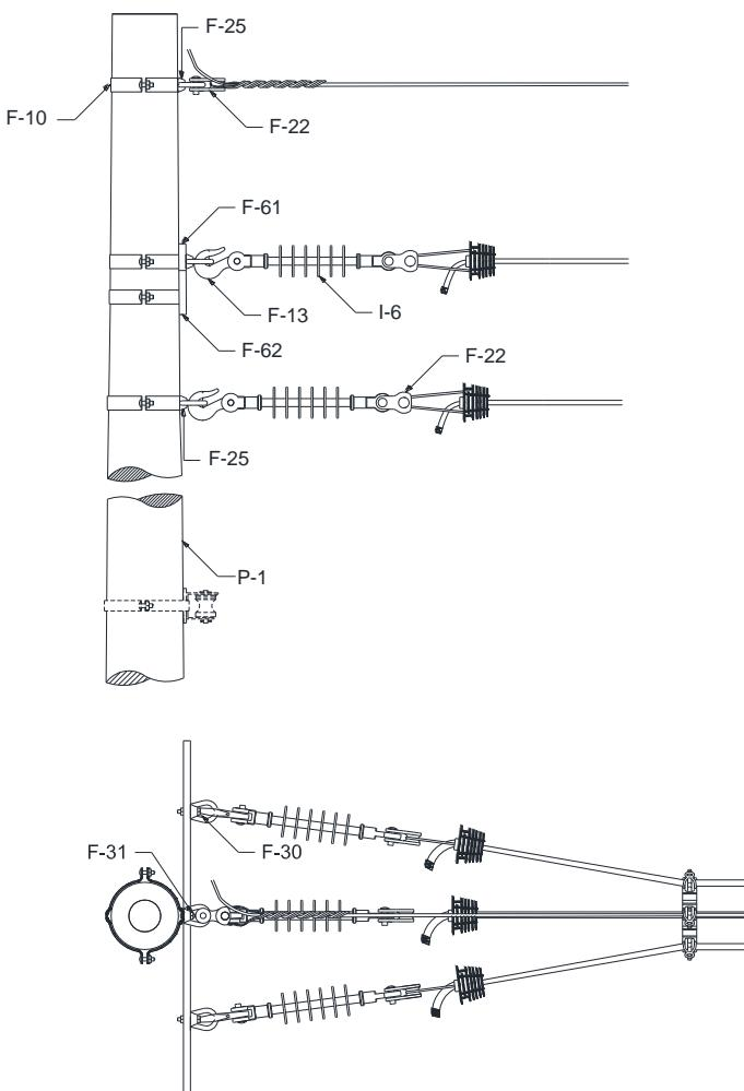
Figura 36 – Estrutura C3A – Poste de concreto de seção circular
