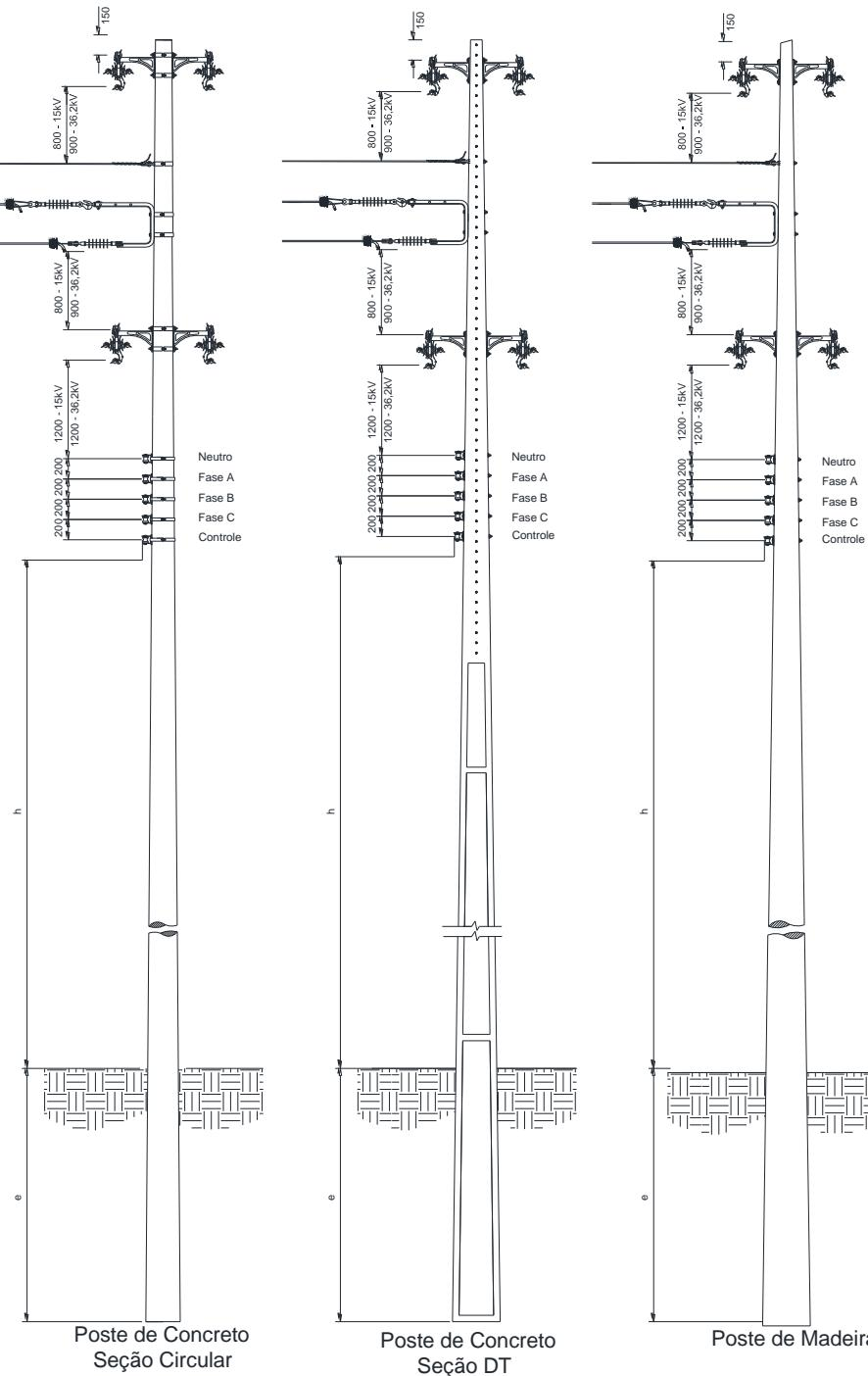
Figura 11 – Afastamentos mínimos – Estruturas trifásicas tangentes e derivação no 1º nível
