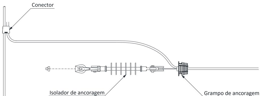
Figura 74 – Amarrasões e ligações – Ancoragem com derivação – Cabo protegido
