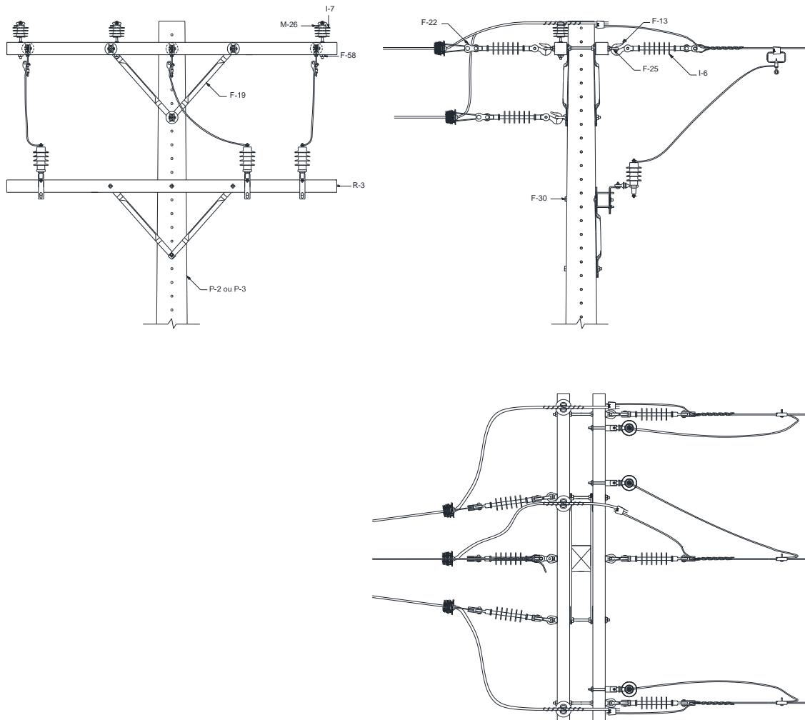
Figura 45 – Estrutura especial – Estrutura N3-C3A
