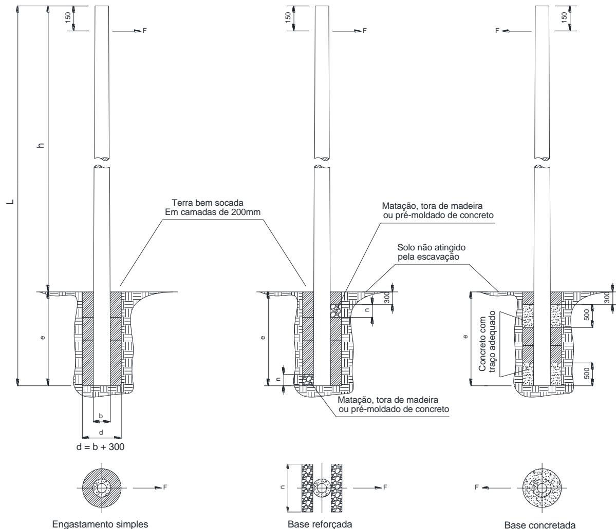
Figura 15 – Engastamento de poste – Detalhe da fundação
