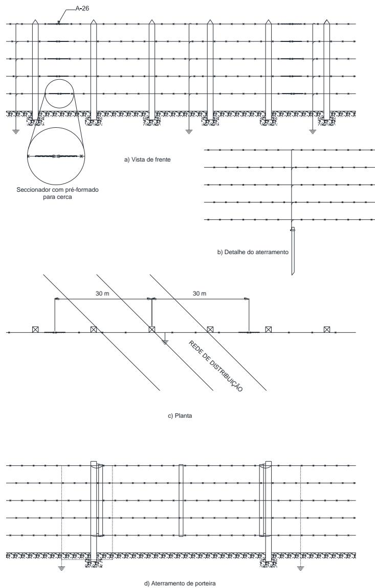
Figura 101 – Seccionamento de cerca – Cerca paralela
