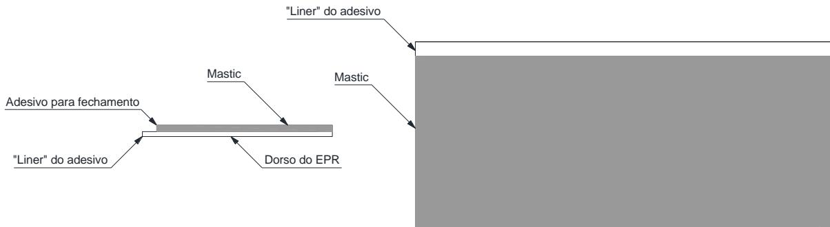
Figura 100 – Conexões e emendas – Manta de cobertura
