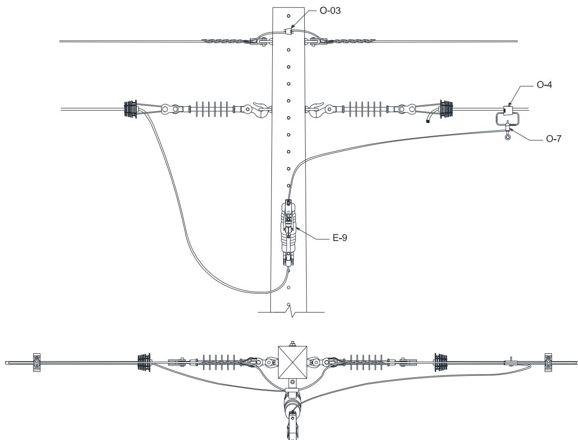
Figura 48 – Instalação de equipamento – Chave fusível em seccionamento – Estrutura monofásica
