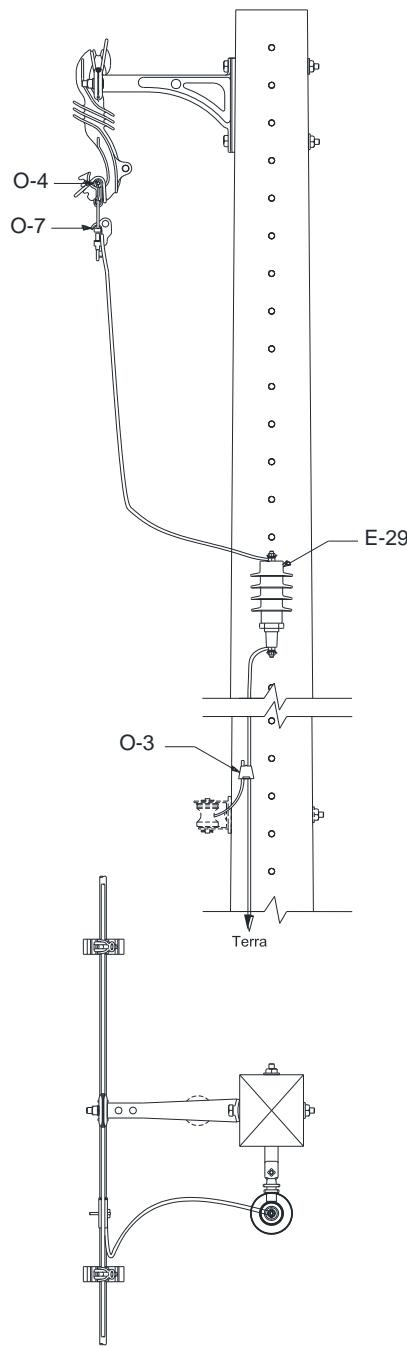
Figura 54 – Instalação de equipamento – Para-raios – Estrutura monofásica
