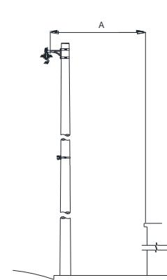
Afastamentos horizontal entre os condutores e a cimalha e o telhado de edificações
