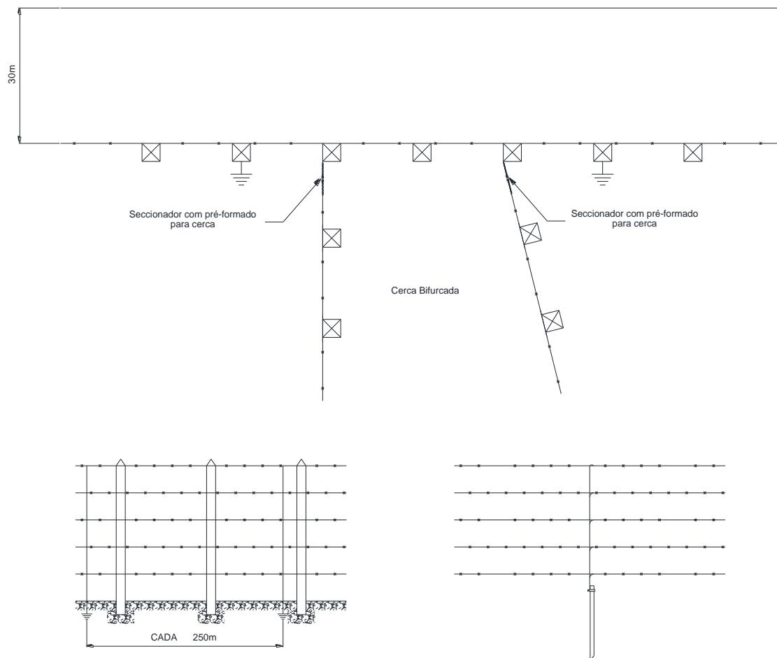
Figura 102 – Seccionamento de cerca – Cercas transversais
