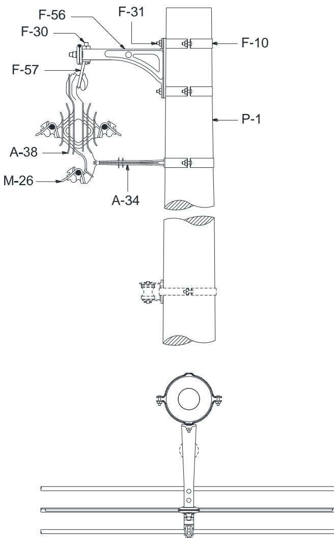
Figura 28 – Estrutura CA1 – Poste de concreto de seção circular
