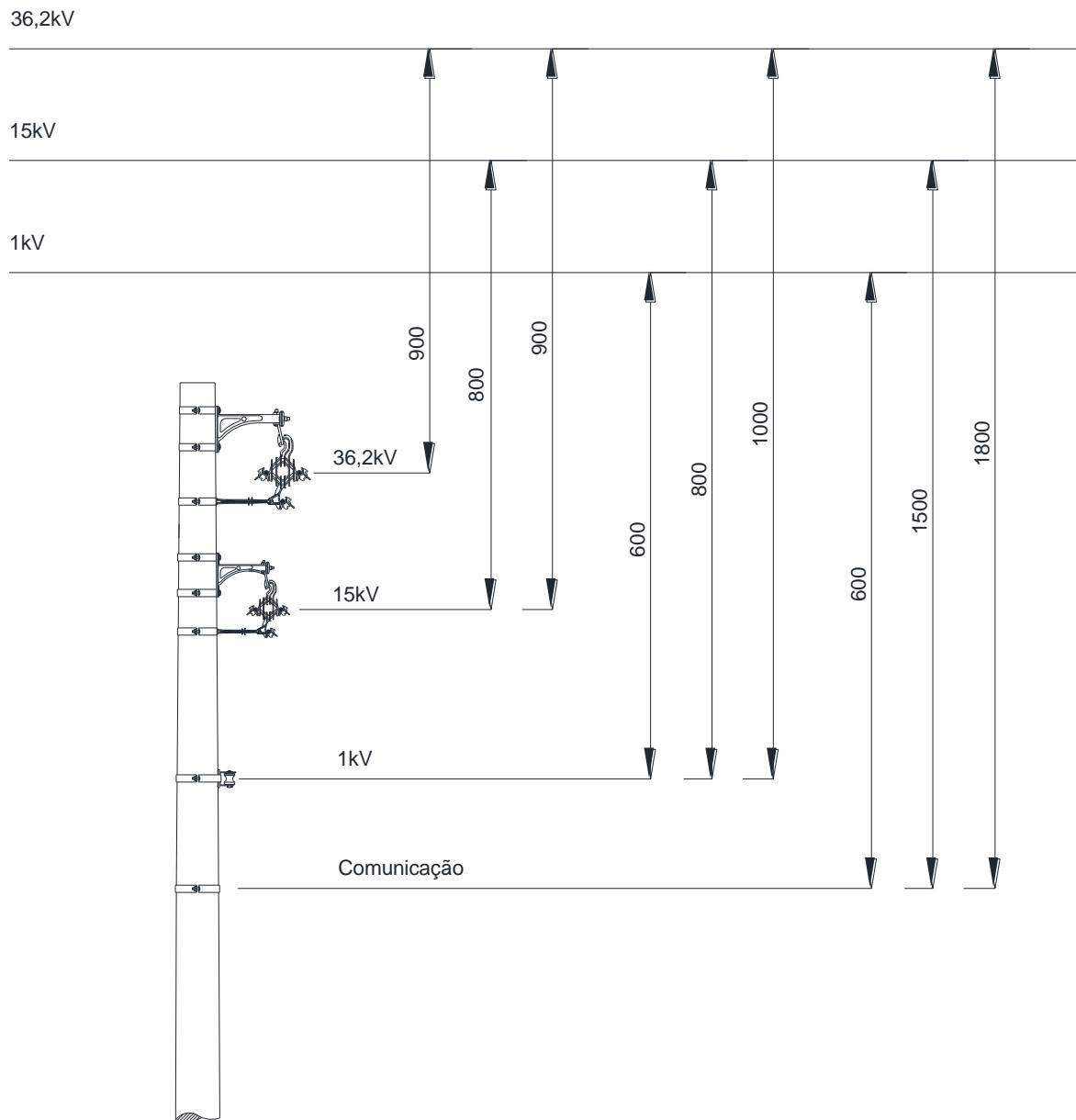
Figura 4 – Afastamentos mínimos – Circuitos diferentes
