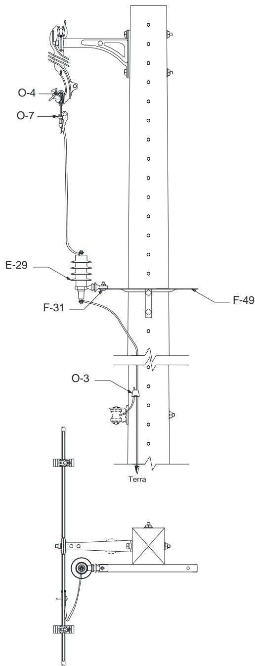
Figura 55 – Instalação de equipamento – Para-raios – Estrutura monofásica – Alternativa
