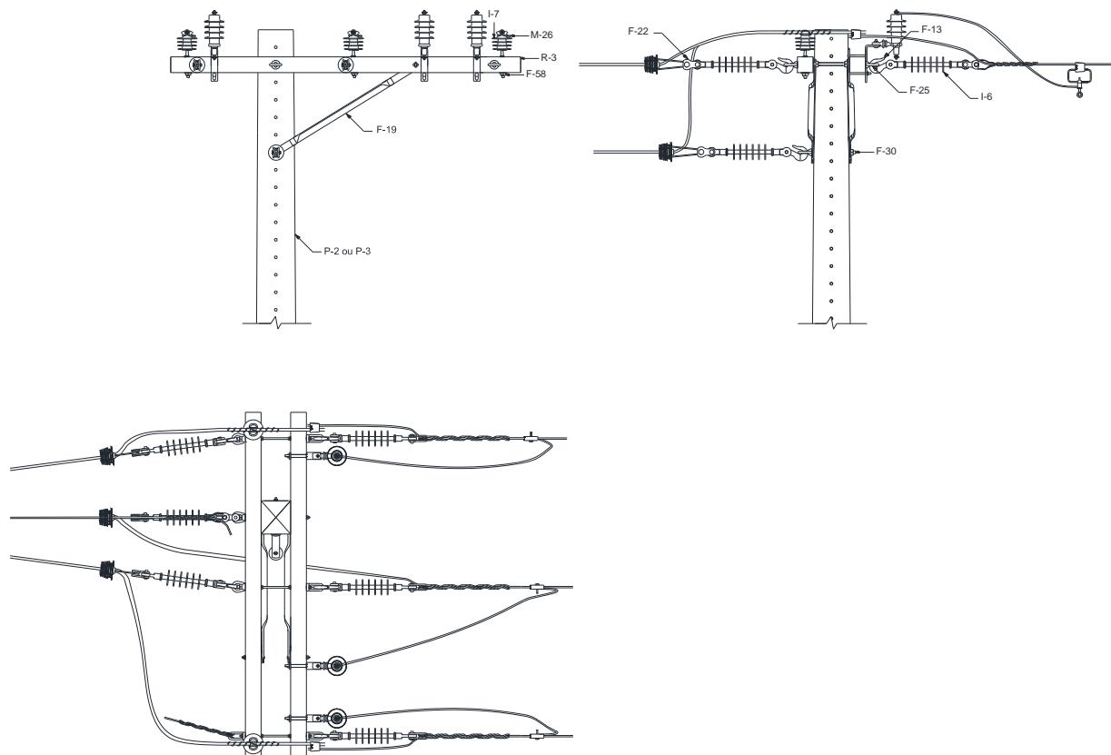
Figura 46 – Estrutura especial – Estrutura M3-C3A
