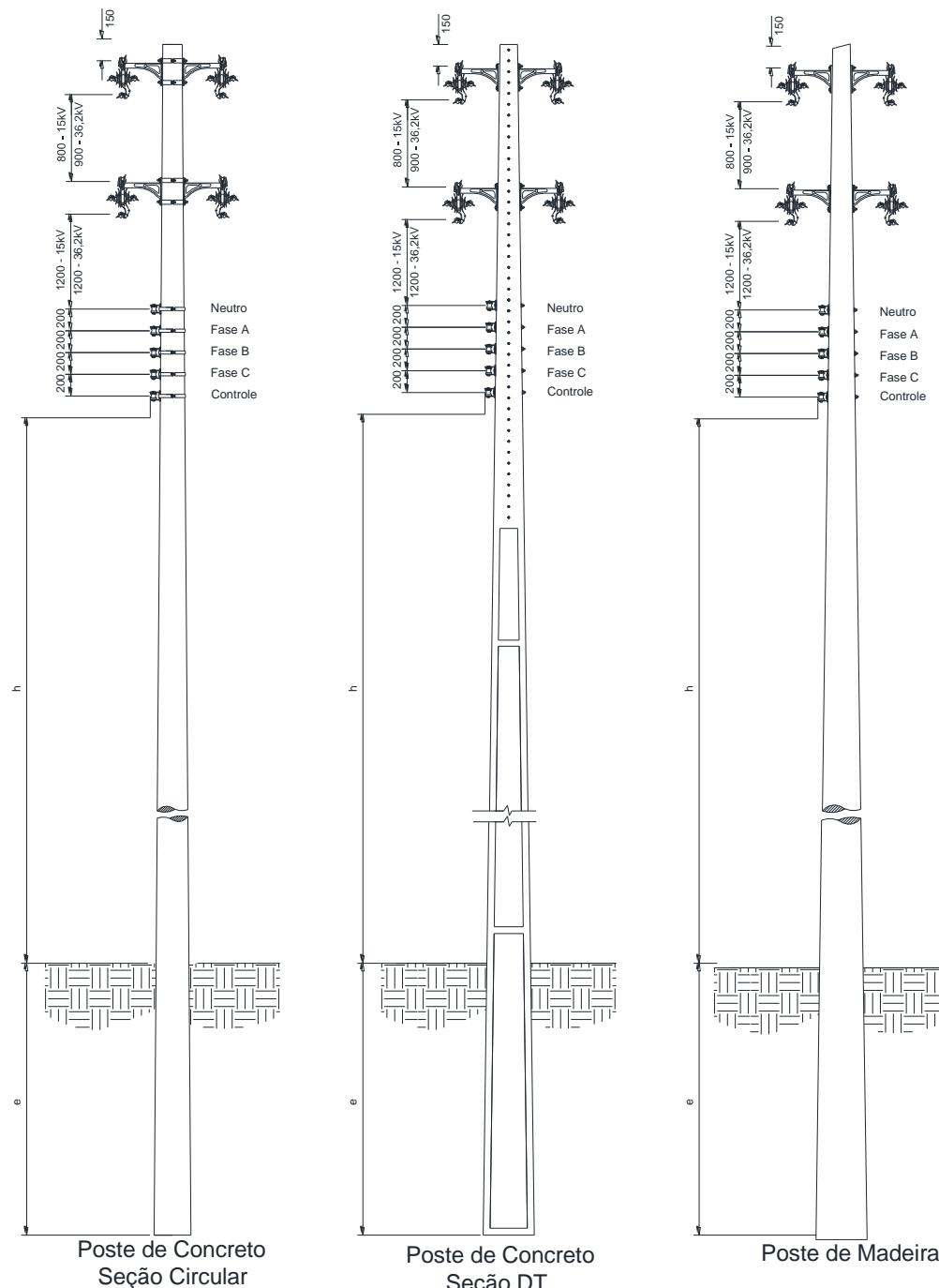
Figura 10 – Afastamentos mínimos – Estruturas trifásicas tangentes
