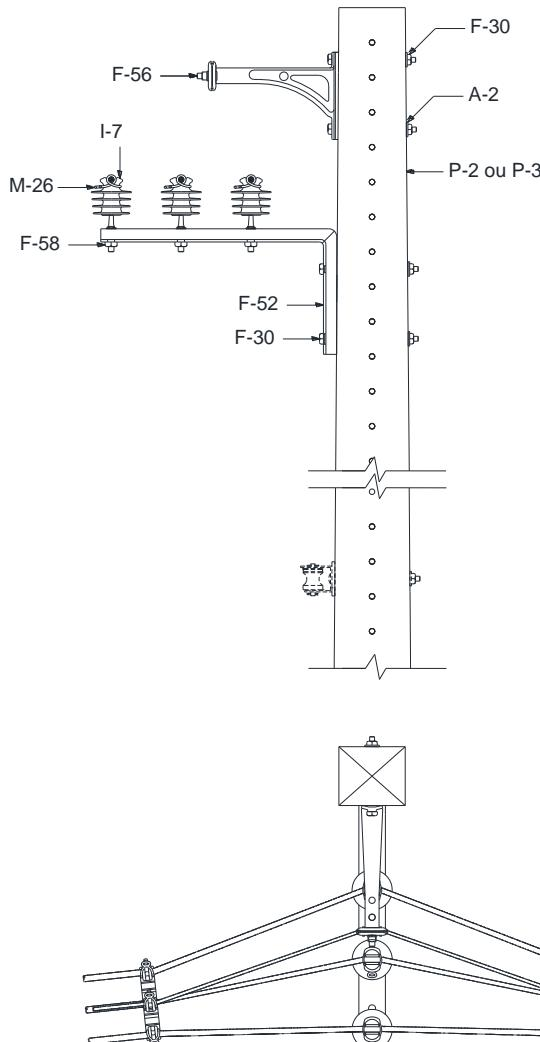
Figura 31 – Estrutura C1H – Poste de concreto de seção DT ou de madeira
