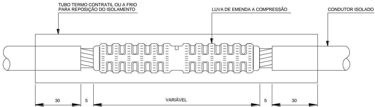
Figura 52 - Emenda do cabo fase - Construção
