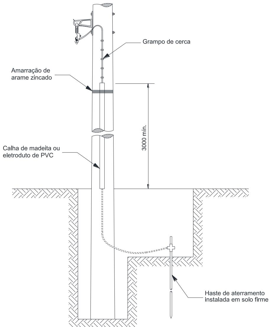
Figura 32 – Aterramento de equipamento – Poste de madeira
