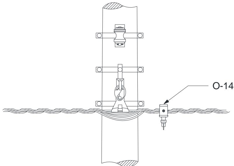
Figura 33 – Aterramento de equipamento – Aterramento temporário
