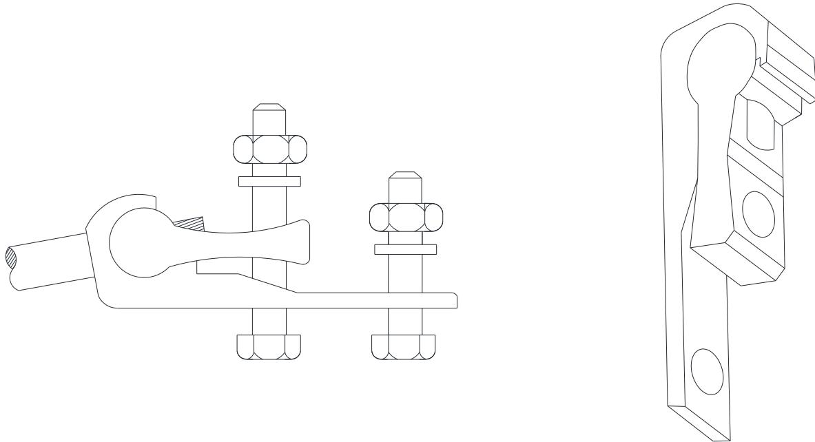
Figura 59 – Conexões e emendas – Conector terminal de estrangulamento
