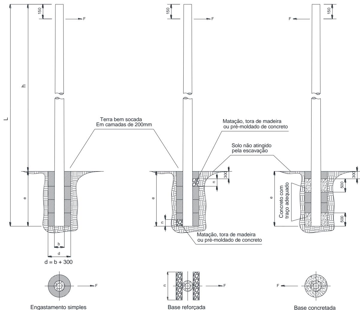
Figura 8 – Engastamento de poste – Detalhe da fundação
