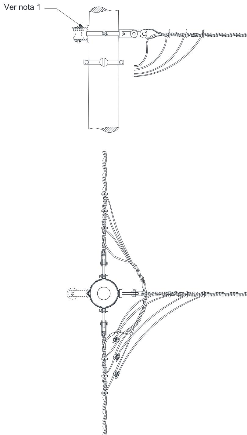
Figura 26 - Estrutura derivação SI4 – SI3
