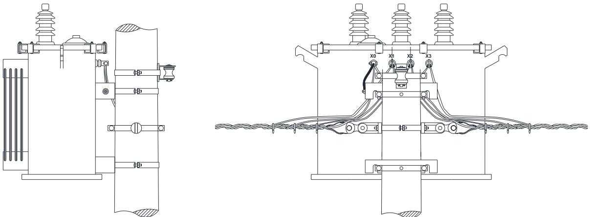
Figura 47 - Instalação de transformador – Barramento duplo
