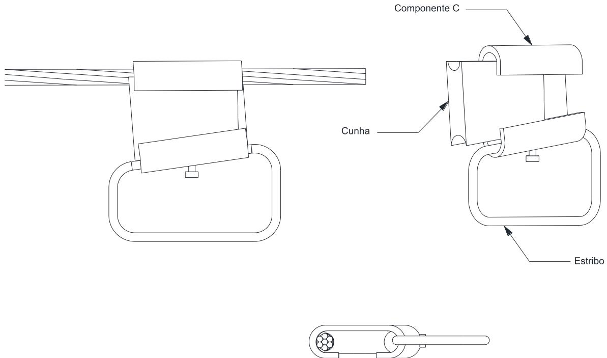
Figura 56 – Conexões – Conector cunha com estribo
