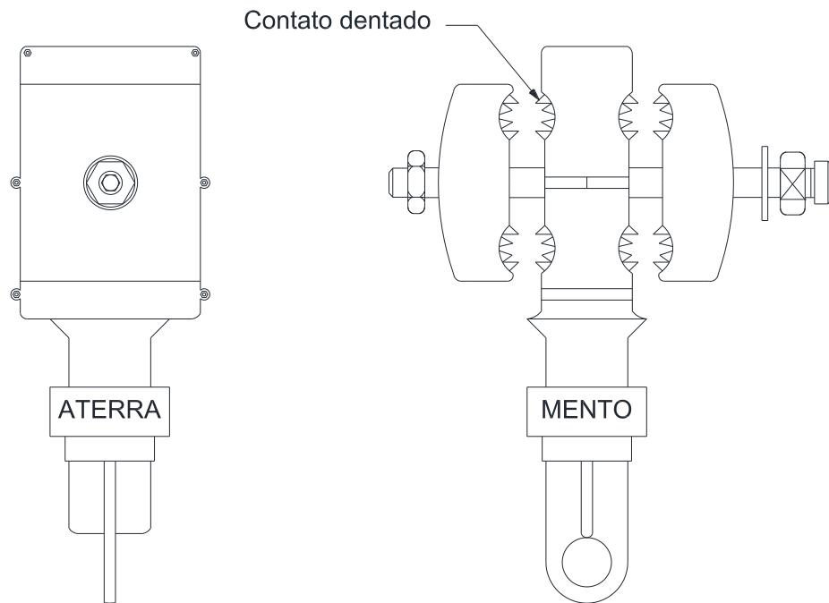
Figura 62 – Conexões e emendas – Conector de aterramento temporário
