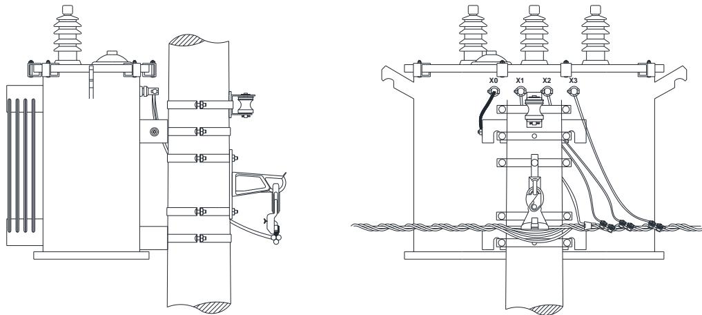
Figura 46 - Instalação de transformador – Barramento simples
