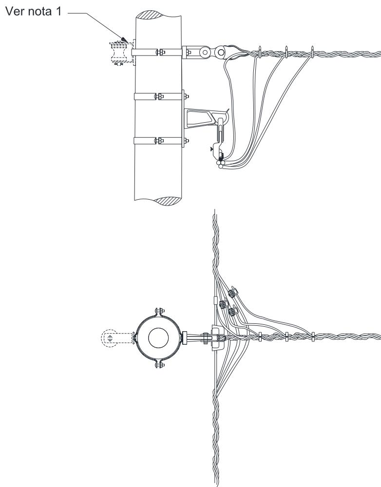
Figura 24 - Estruturas derivação tangente – SI1 – SI3
