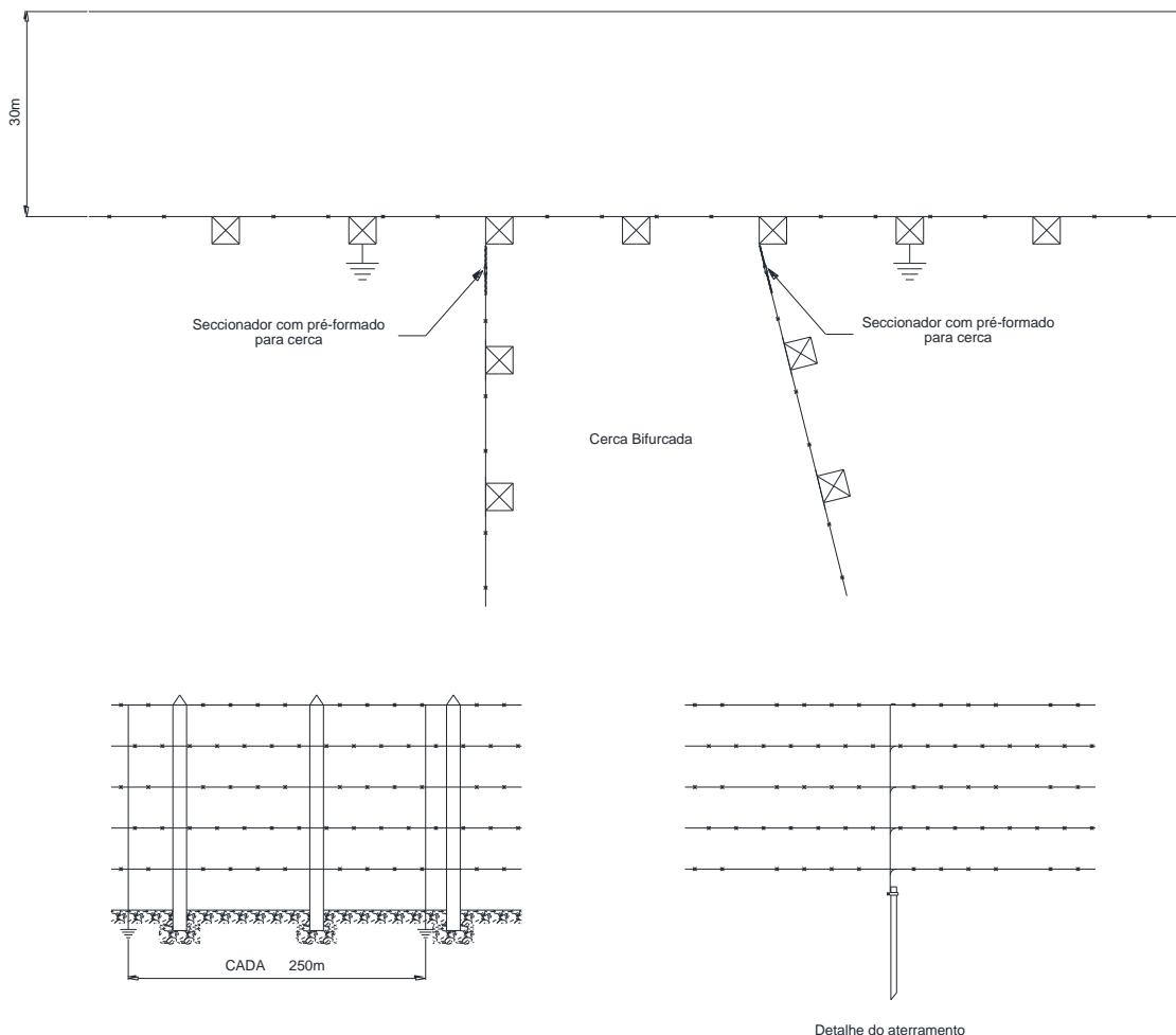
Figura 64 – Seccionamento de cerca – Cercas transversais
