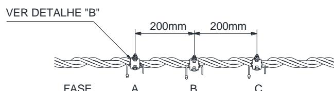
Figura 50 - Ramal de ligação – conexão à rede
