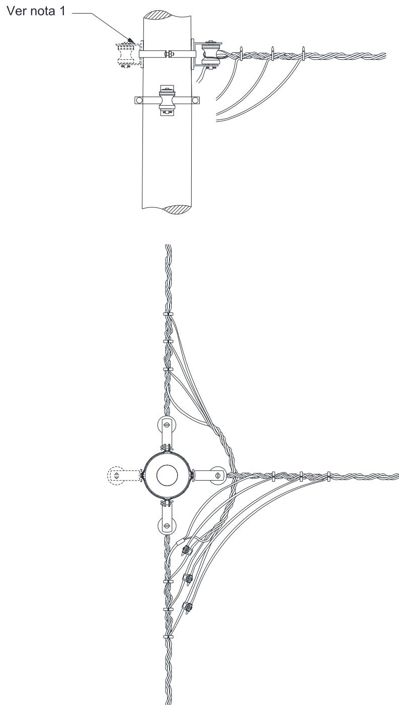
Figura 27 - Estrutura derivação SI 4 – SI3 (alternativa)
