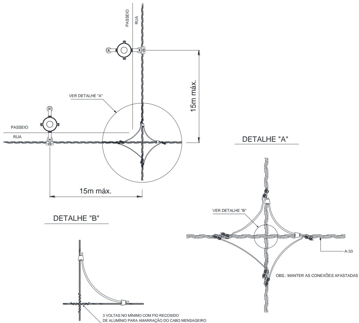
Figura 44 - Estrutura conexão no vão (FLY – TAP)
