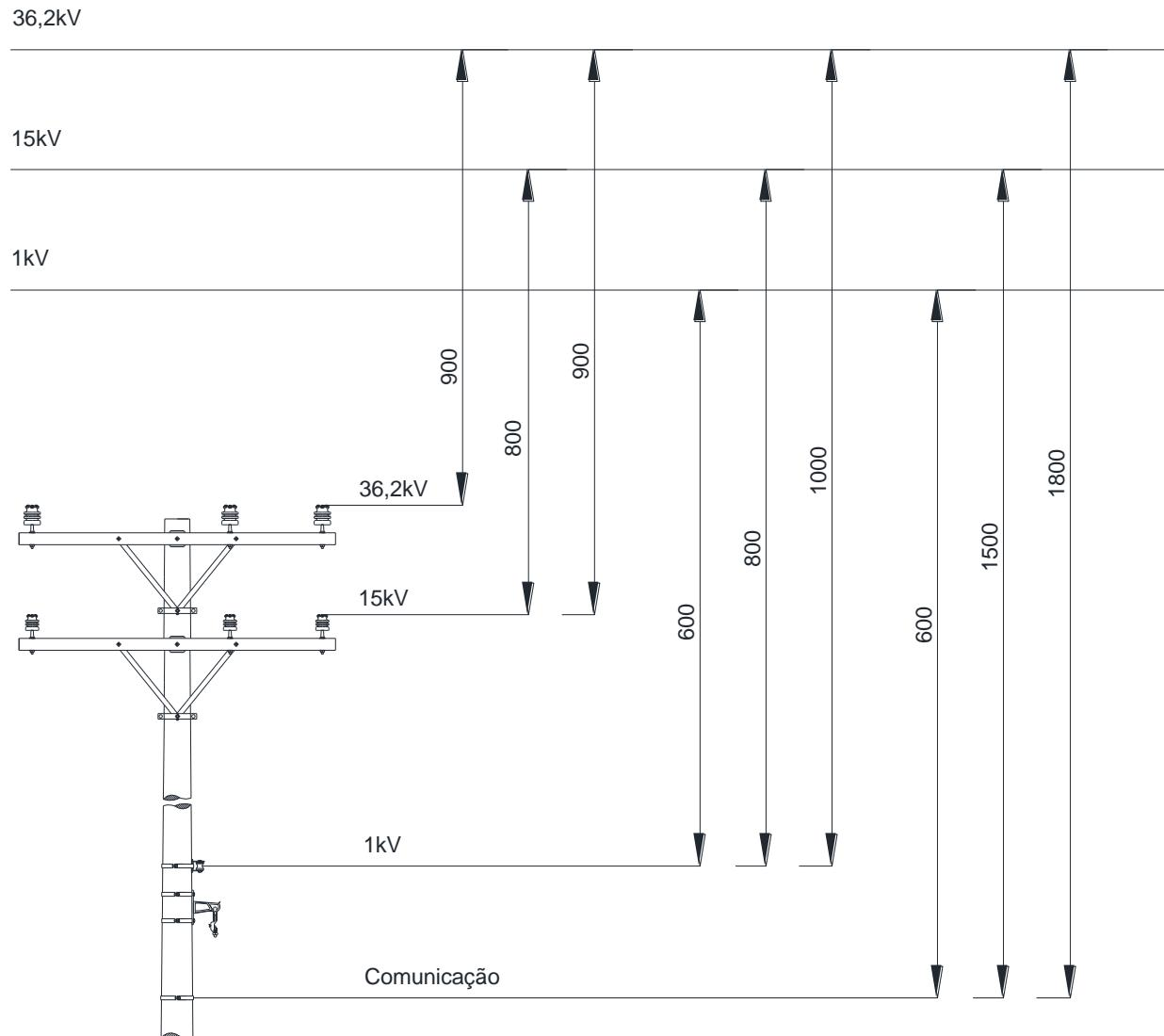
Figura 3 – Afastamentos mínimos – Circuitos diferentes
