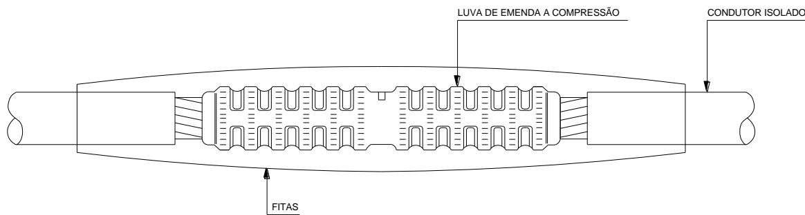
Figura 53 - Emenda do cabo fase - Manutenção
