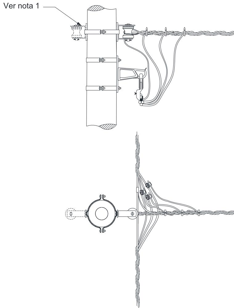
Figura 25 - Estruturas derivação tangente – SI1 – SI3 (alternativa)
