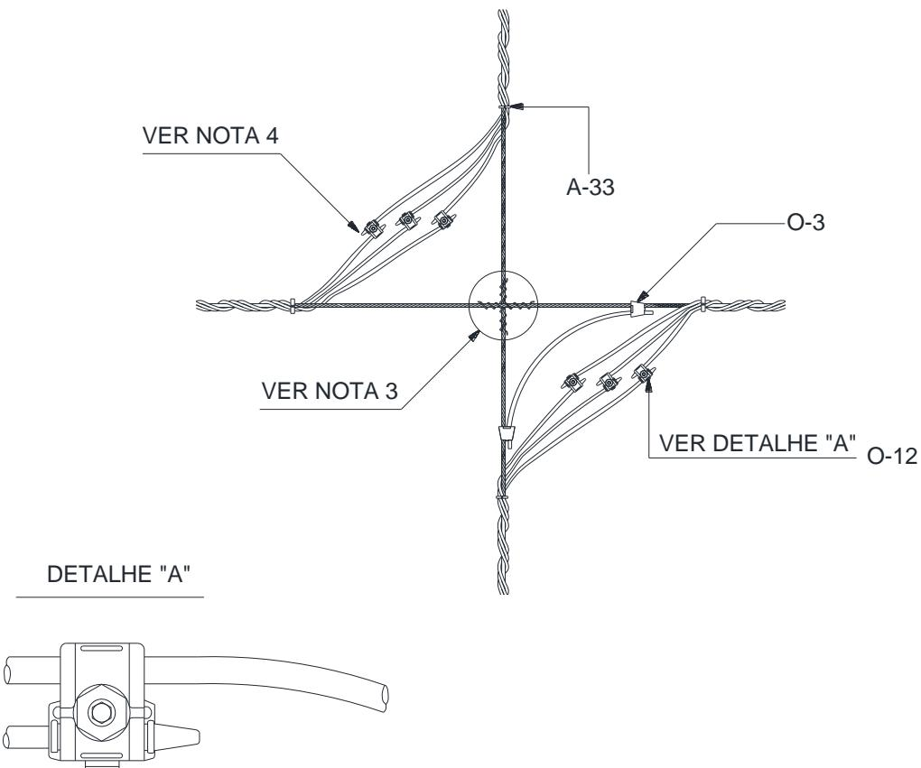
Figura 45 - Estrutura cruzamento sem conexão no vão
