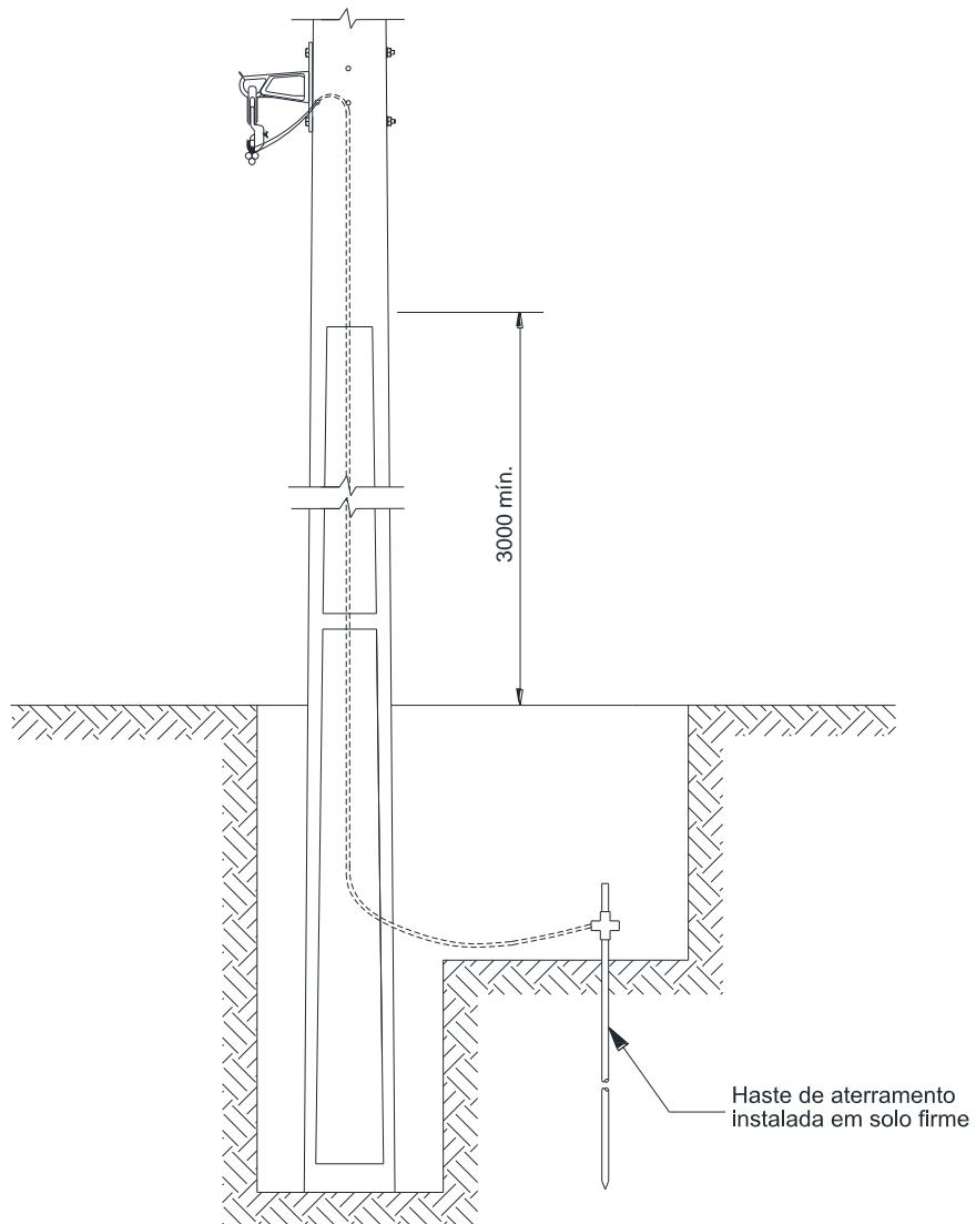
Figura 31 – Aterramento de equipamento – Poste de concreto
