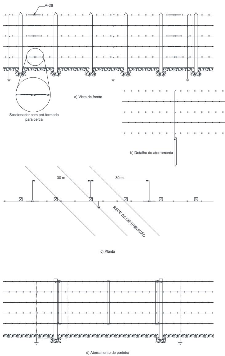
Figura 63 – Seccionamento de cerca – Cerca paralela
