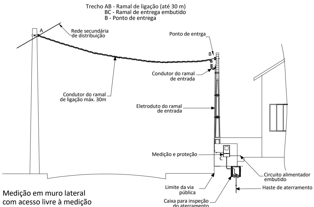
**Figura 5- Padrão de entrada caixa de medição tipo II instalação ao tempo**
