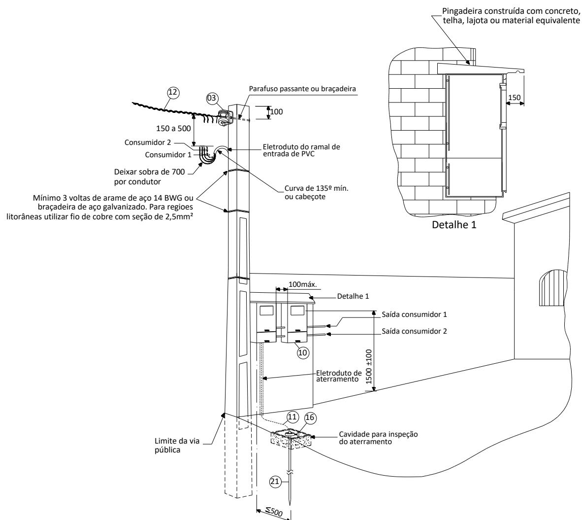
**Figura 8- Padrão de entrada caixa de medição tipo II instalação com pontalete**
