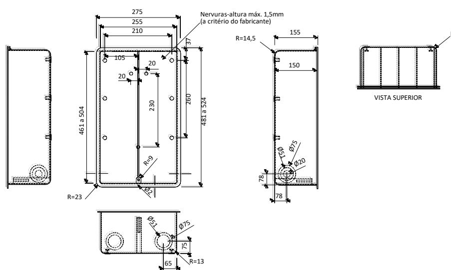
**Figura 38 - Padrão de entrada com caixa de medição com lente**
