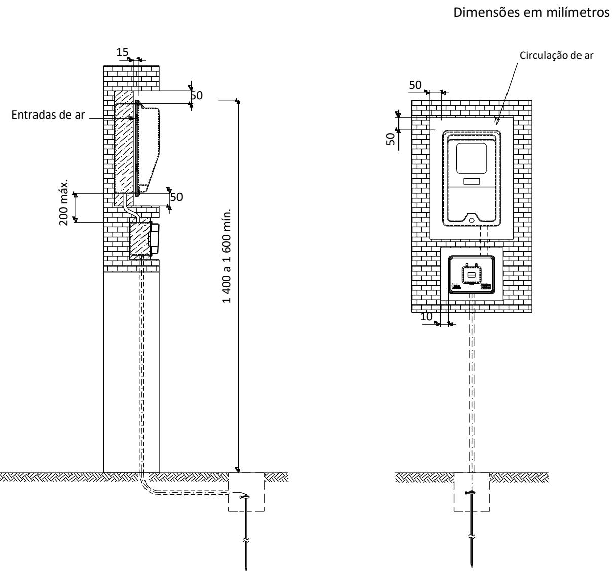
**Figura 16 - Padrão de entrada caixa de medição tipo E instalação ao tempo**
