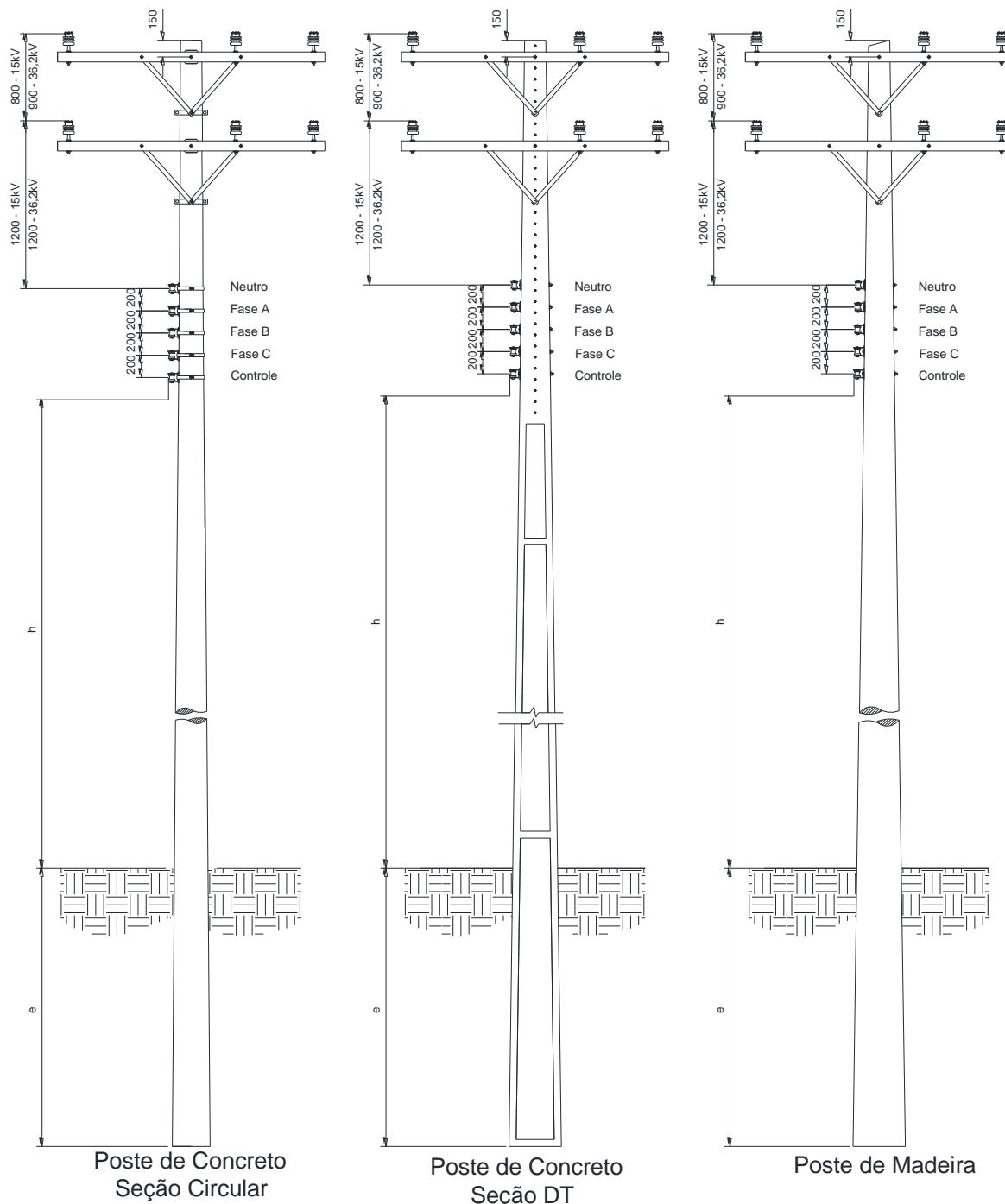
Figura 11 – Afastamentos mínimos – Estruturas trifásicas tangentes
