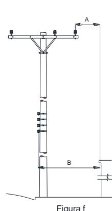
Afastamento horizontal entre os condutores e a cimálha e o telhado de edificações
