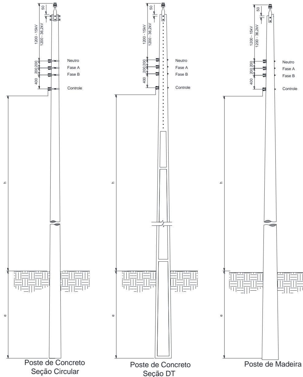
Figura 7 – Afastamentos mínimos – Estrutura monofásica tangente
