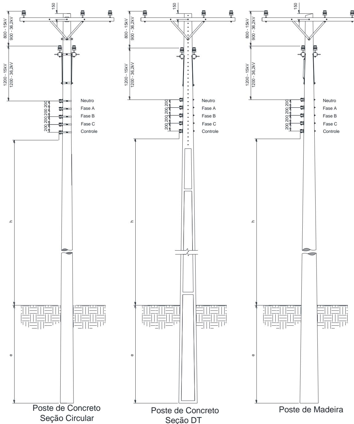
Figura 10 – Afastamentos mínimos – Estruturas trifásicas tangentes com derivações
