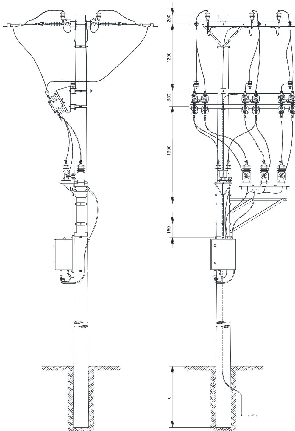
Figura 140 – Instalação de equipamento – Religador – Seccionamento tipo faca “by-pass” – Para-raios no 1º nível
