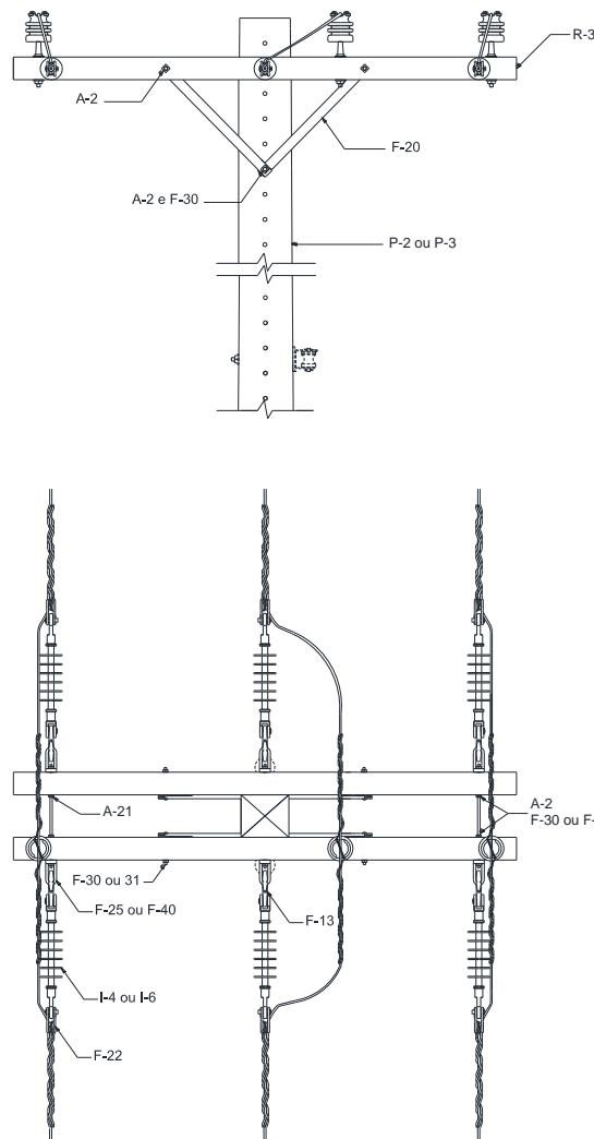
Figura 48 – Estrutura N4 – Poste de concreto de DT ou de madeira
