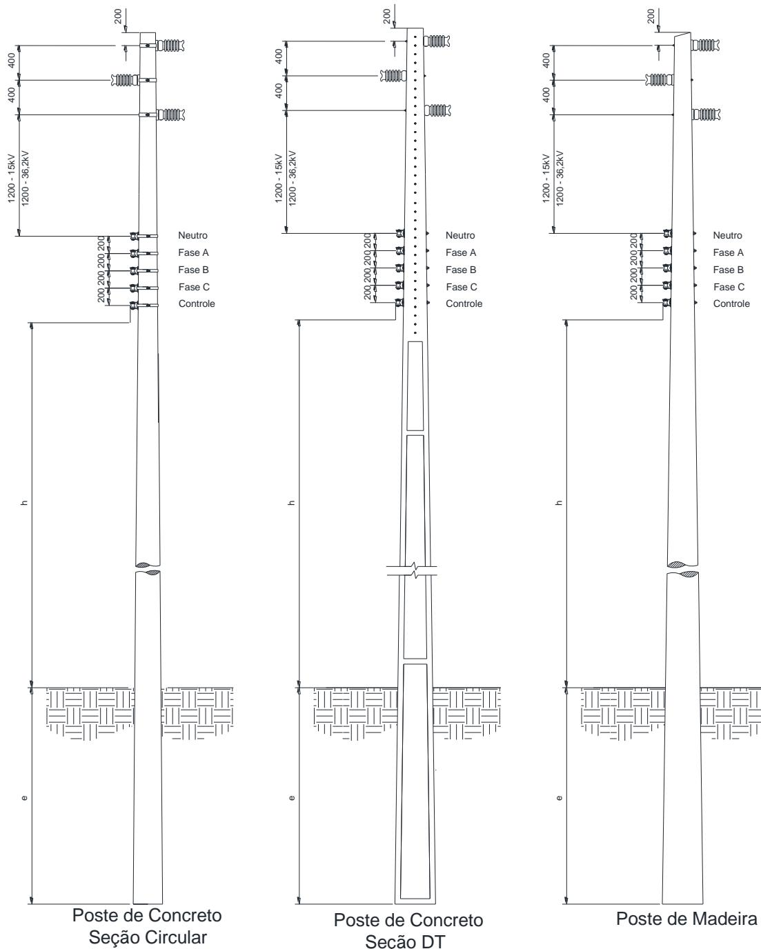
Figura 15 – Afastamentos mínimos – Estrutura pilar trifásica tangente
