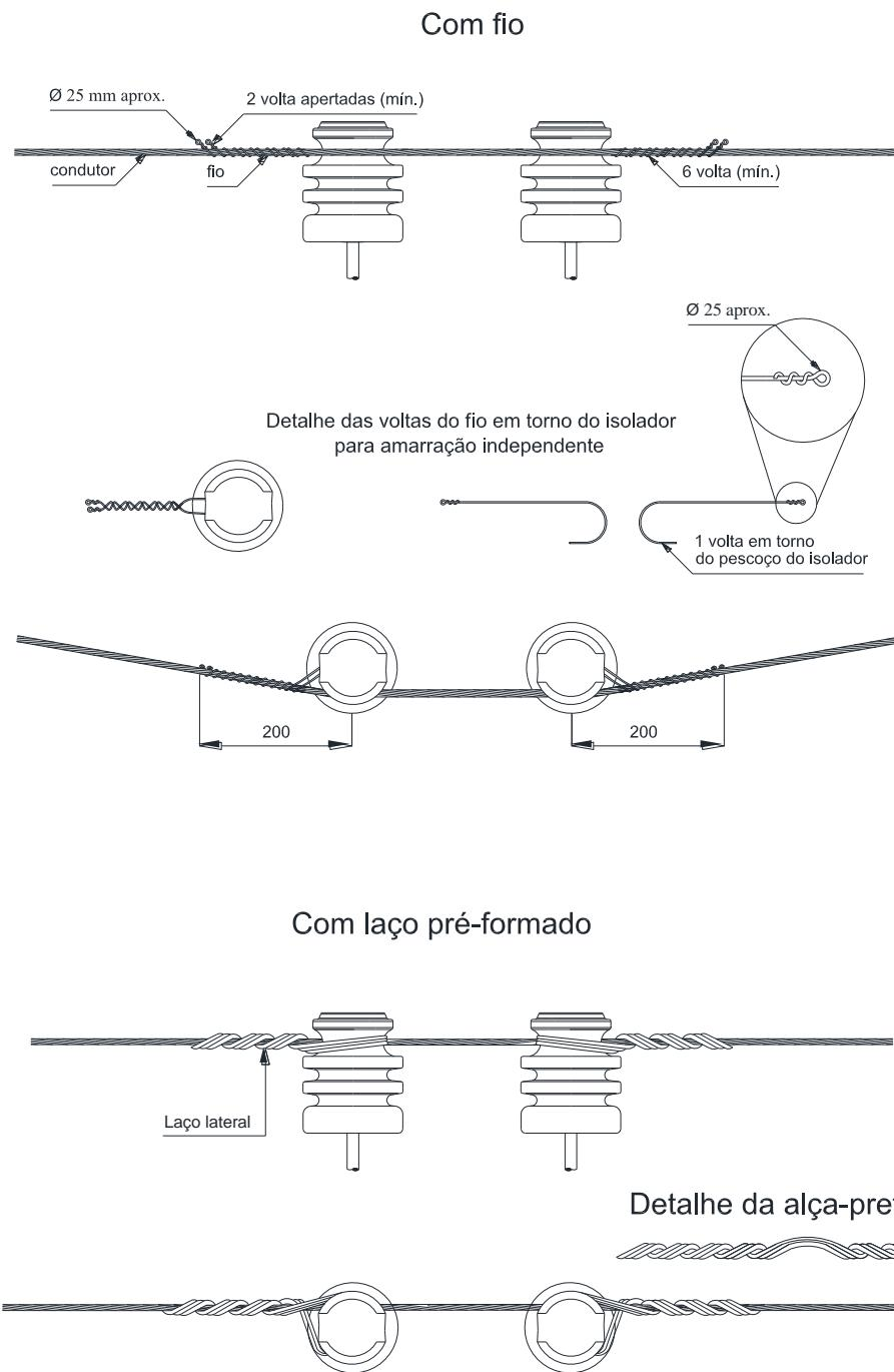
Figura 162 – Amarrações e ligações – Estrutura primária – Amarração lateral com fio e fita
