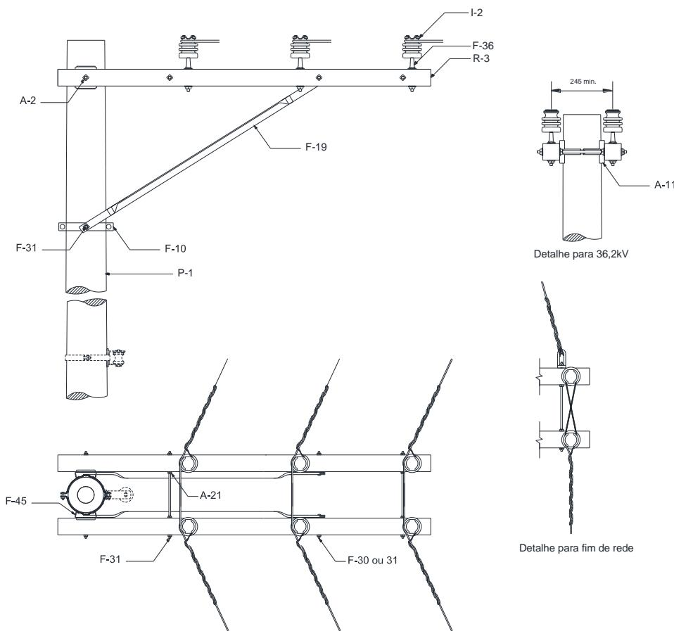
Figura 61 – Estrutura B2 – Poste de concreto de seção circular
