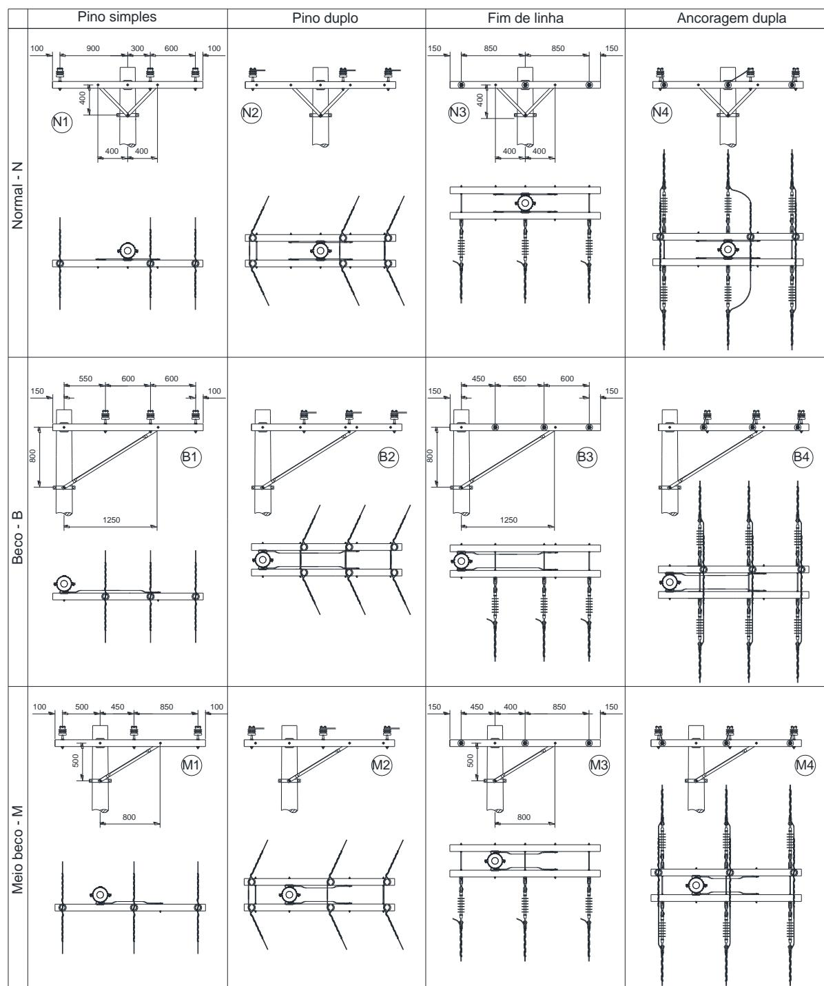
Figura 23 – Afastamentos de condutores – Cruzeta de 2000mm
