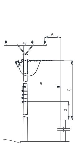
Afastamento horizontal e vertical entre os condutores e o muro
