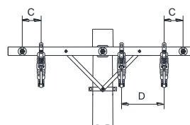
Normal - Estrutura com isolador de ancoragem
