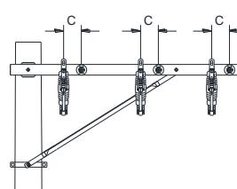
Beco - Estrutura com isolador de ancoragem
