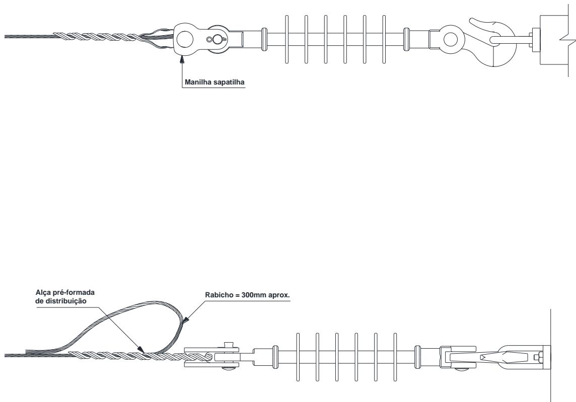
Figura 156 – Amarrações e ligações – Estrutura primária – Ancoragem simples
