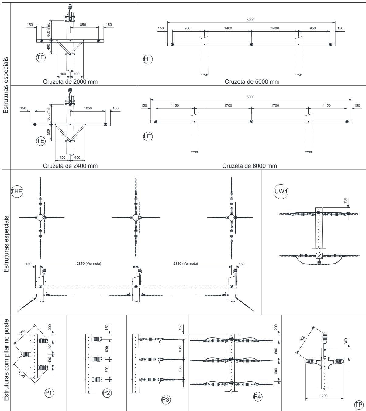
Figura 25 – Afastamentos de condutores – Estruturas especiais
