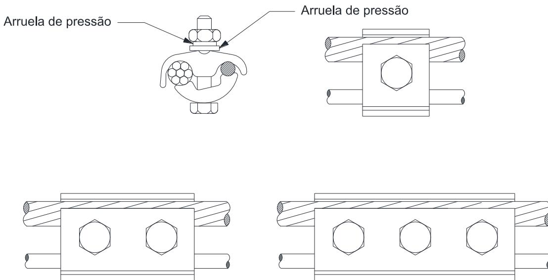
Figura 171 – Conexões – Conector paralelo (1 ou 2 parafusos)
