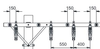
Meio beco - Estrutura com isolador de ancoragem
