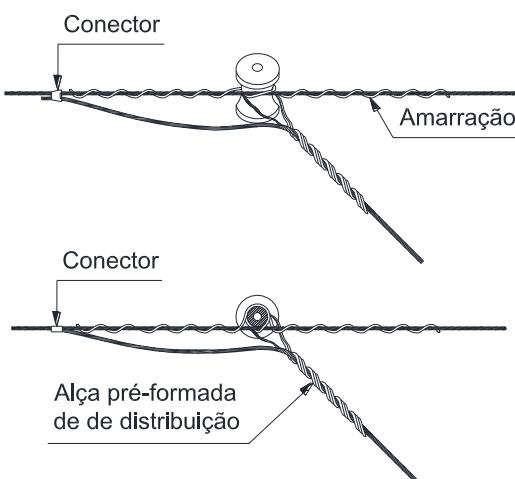
Figura 153 – Amarragens e ligações – Estrutura secundária – Encabeçamento duplo e derivação
