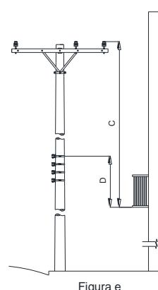
Afastamento horizontal entre os condutores e a parede de edificações
