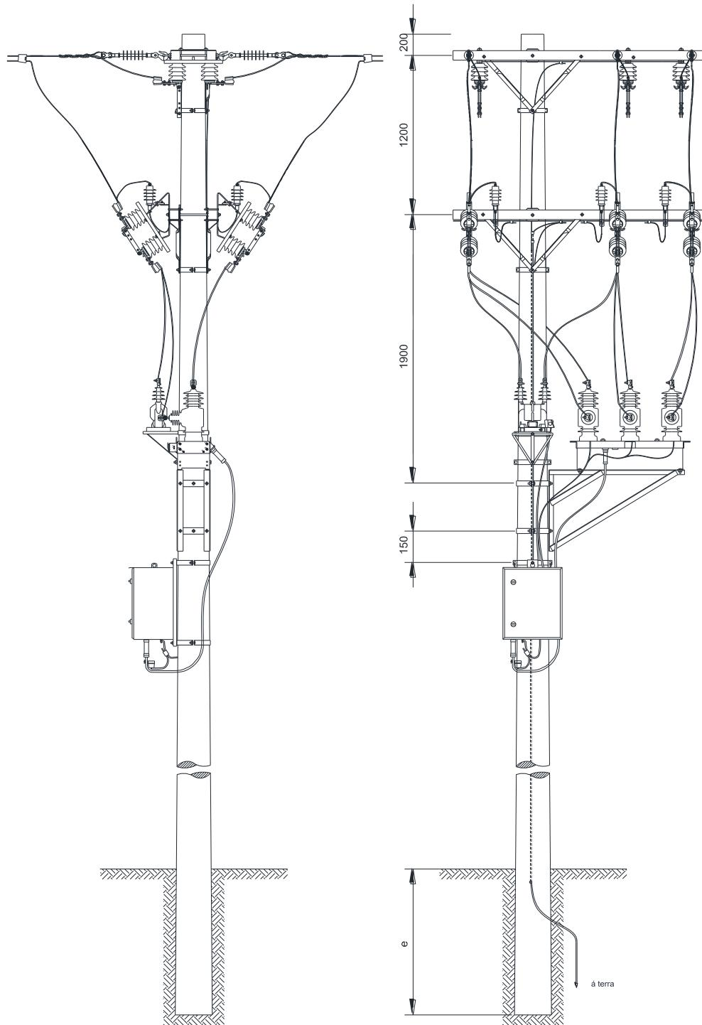
Figura 139 – Instalação de equipamento – Religador – Seccionamento tipo faca – Para-raios no 2º nível.
