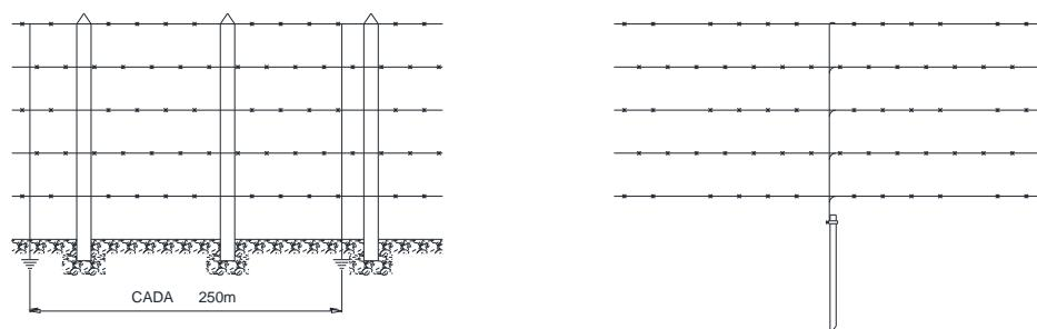
Figura 173 – Seccionamento de cerca – Cercas transversais
