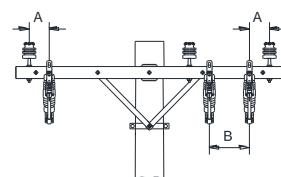
Normal - Estrutura com isolador tipo pino
